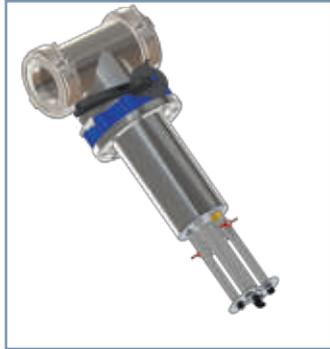
Pour le nettoyage, il suffit d'isoler la zone de captation en fermant la vanne papillon, de faire coulisser le bloc magnétique hors de son logement puis de vidanger la chambre de captation. Avec leur fourreau étanche, les barreaux magnétiques haute puissance restent propres, sans risque de se salir pour l'opérateur.
