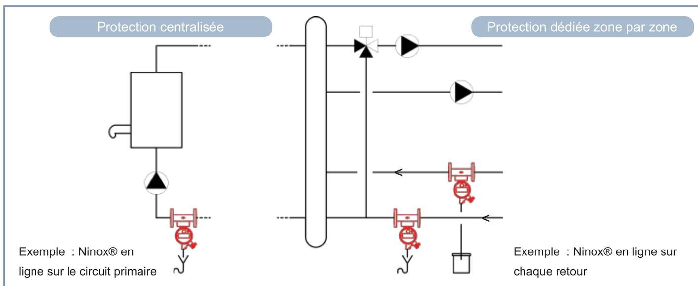
Grâce à ses dimensions normalisées (brides + entraxe), Ninox® peut s'installer en lieu et place d'un filtre Y à tamis normalisé **si ce dernier n'a plus d'utilité**, pour une nouvelle protection exclusivement dédiée aux boues ferriques (magnétite).
