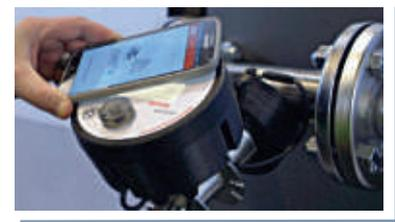
> L'application Smartphone\* développée par temiQ permet de récupérer aisément ces données via une connexion RFID. Elle donne aussi accès à la version en ligne de la documentation et notice d'installation du produit.
