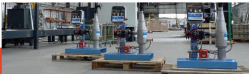
Fabrication de stations de filtration automatisées HS50 dans l'usine TEMIQ (Vaugneray - 69)
